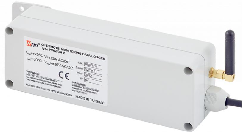
O design autónomo, alimentado por bateria, proporciona um funcionamento prolongado sem necessidade de serviço em locais remotos, poupa fontes de alimentação externas dispendiosas ou sistemas de energia solar. O design industrial duradouro e a ampla gama de temperaturas de funcionamento asseguram um fluxo ininterrupto de informação de locais remotos severos, pode ser especialmente importante durante o Inverno.
