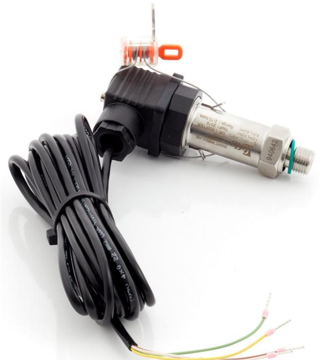
Es ist darauf zu achten, dass bei der EPL Ga (Zone 0) der Massenanteil des Steckermaterials aus nicht mehr als 10 % Aluminium und nicht mehr als 7,5 % Magnesium, Titan bzw. Zirkon besteht. Der Schutz der Steckervariante ist nur mit der zwischen Stecker und Gegenstecker montierten Dichtung gewährleistet.
